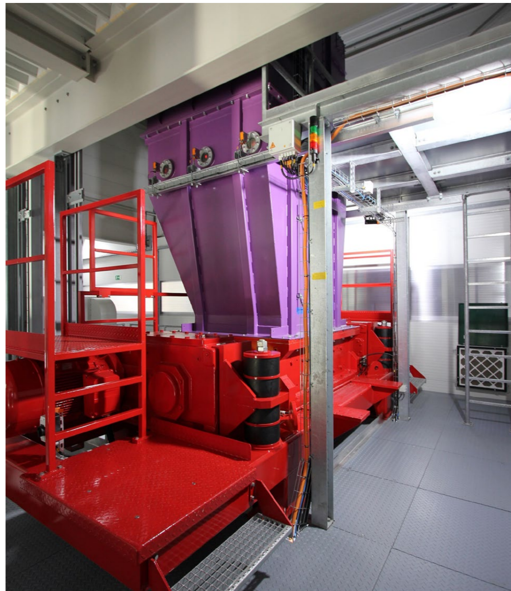
Am Ende des Prozesses wird der Brei in Metallbehälter entleert, worin die Masse zu den endgültigen Zementquadern erstarrt.
